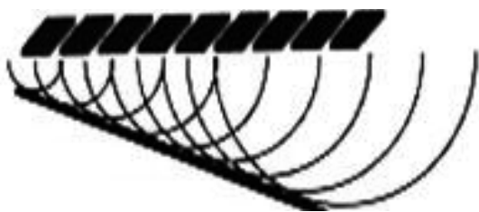
图3 相控阵超声声束偏转原理图
