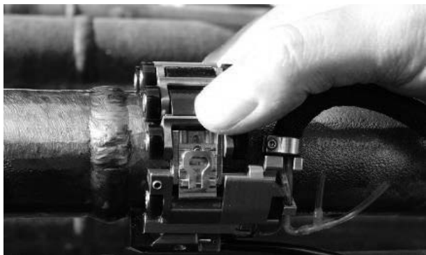
图 19 应用相控阵超声检测则可轻易实现狭窄间隙的全周扫查
