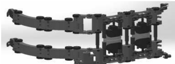
图 18 后水冷壁上部对接接头检测，常规小径管超
