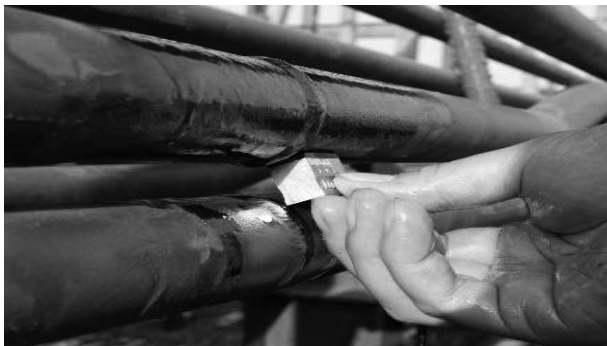
图 18 后水冷壁上部对接接头检测，常规小径管超
