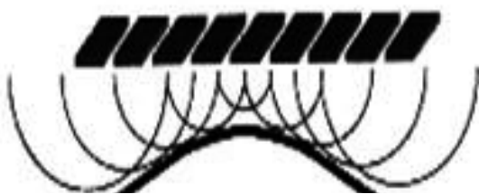
图2 相控阵超声声束聚焦原理图
