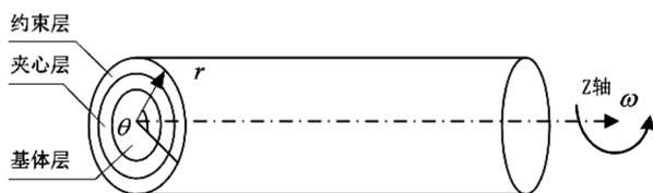
图 2.1 旋转粘弹性夹层梁模型示意图
