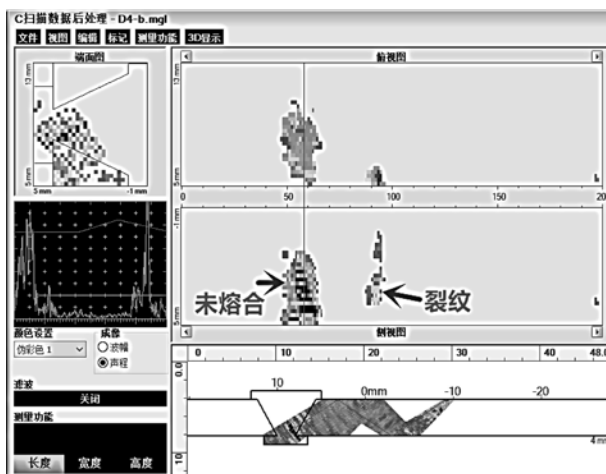
图 5 D4 焊口三次波扫查数据分析缺陷示意图
