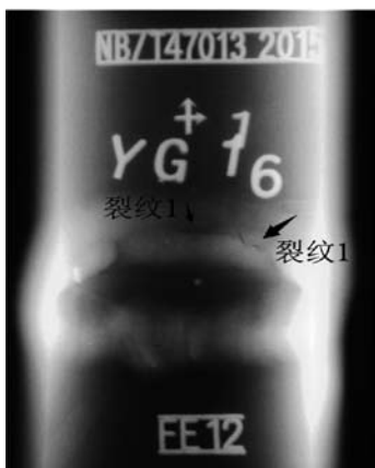
图 2 YG16 试样管的射线检测底片 (裂纹)
