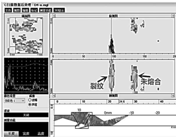
图 4 D4 焊口二次波扫查数据分析缺陷示意图
