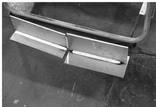
焊接机器人焊接与焊工焊接对比 (右者为焊工焊, 左者为焊接机器人焊)
