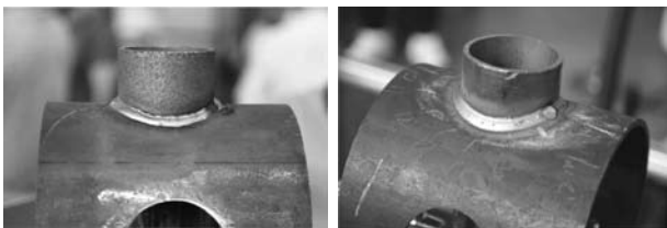
焊接机器人焊接焊缝展示 焊工焊接焊缝展示
